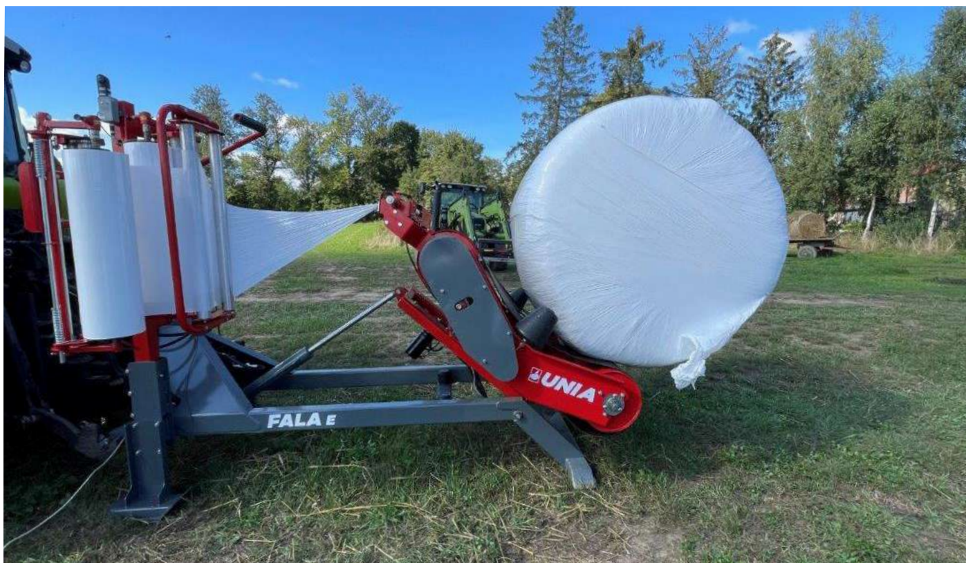
zdj. 6 - hydrauliczny rozładunek balotu
