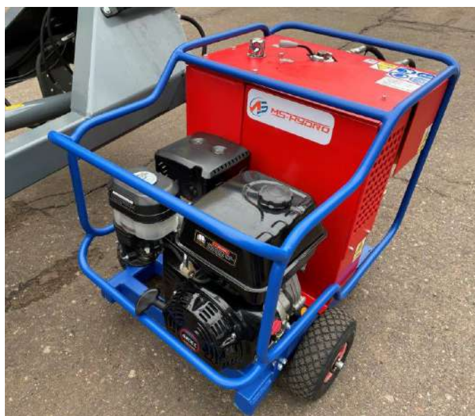
zdj.2 - agregat hydrauliczny
