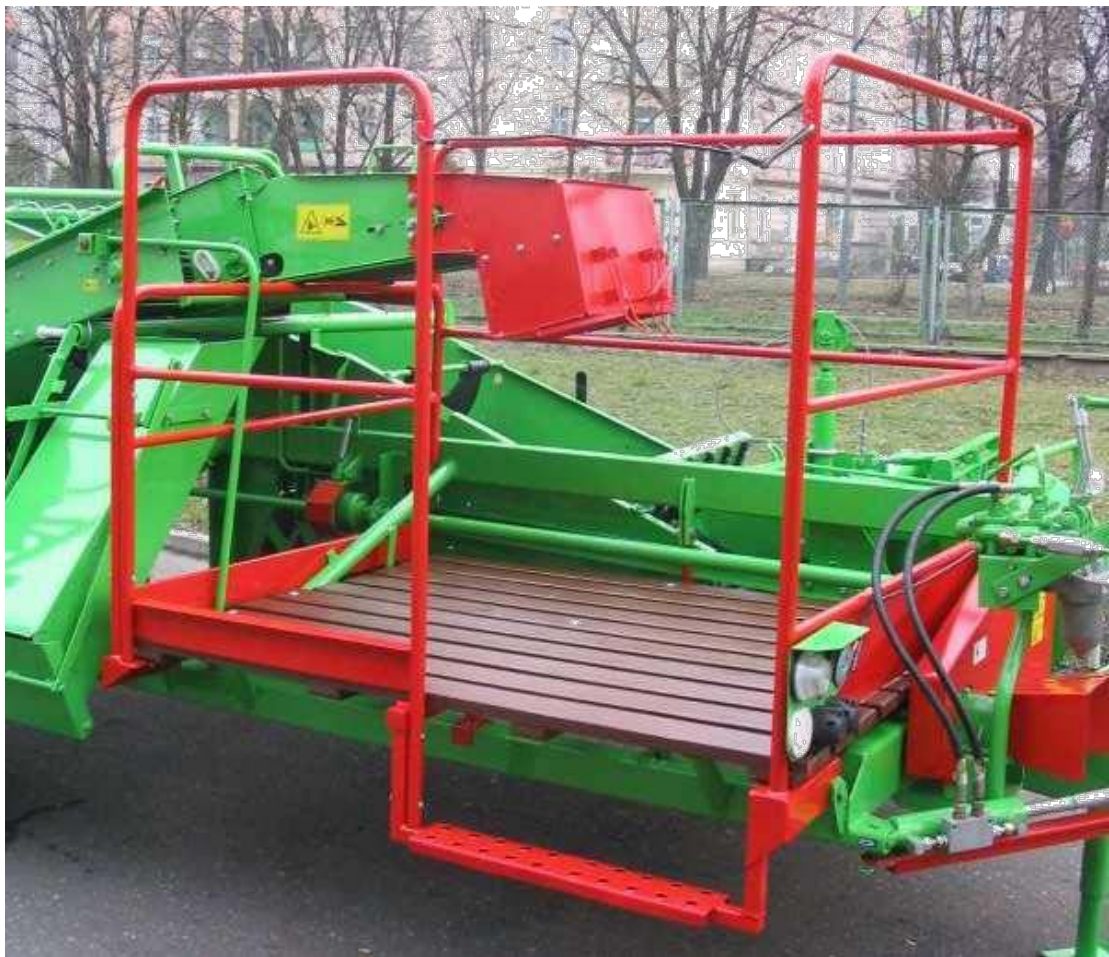
Abb. 39 Kombi mit der montierten Plattform und der Absackmaschine
