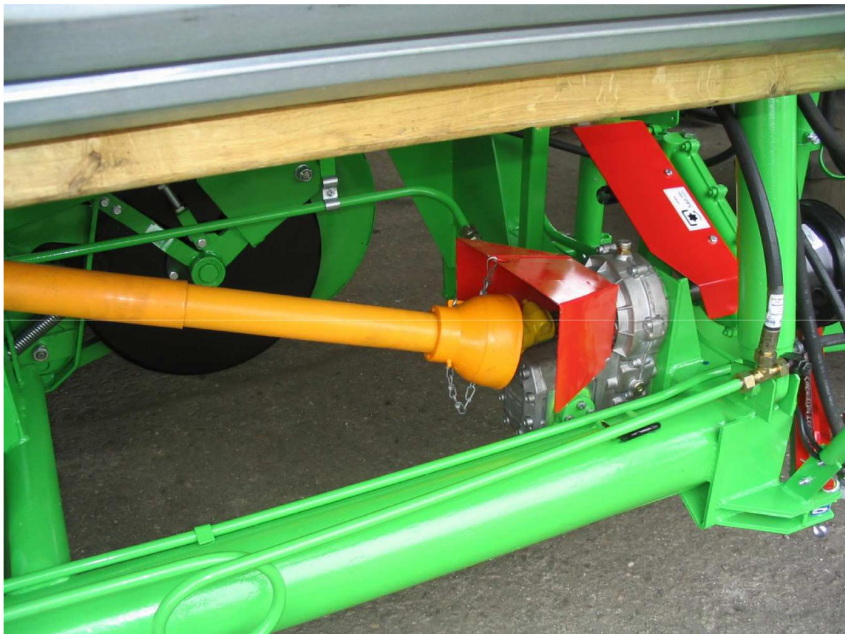
Abb. 20. Getriebe mit zwei Ausgängen für die mittlere teleskopische-Gelenkwelle
