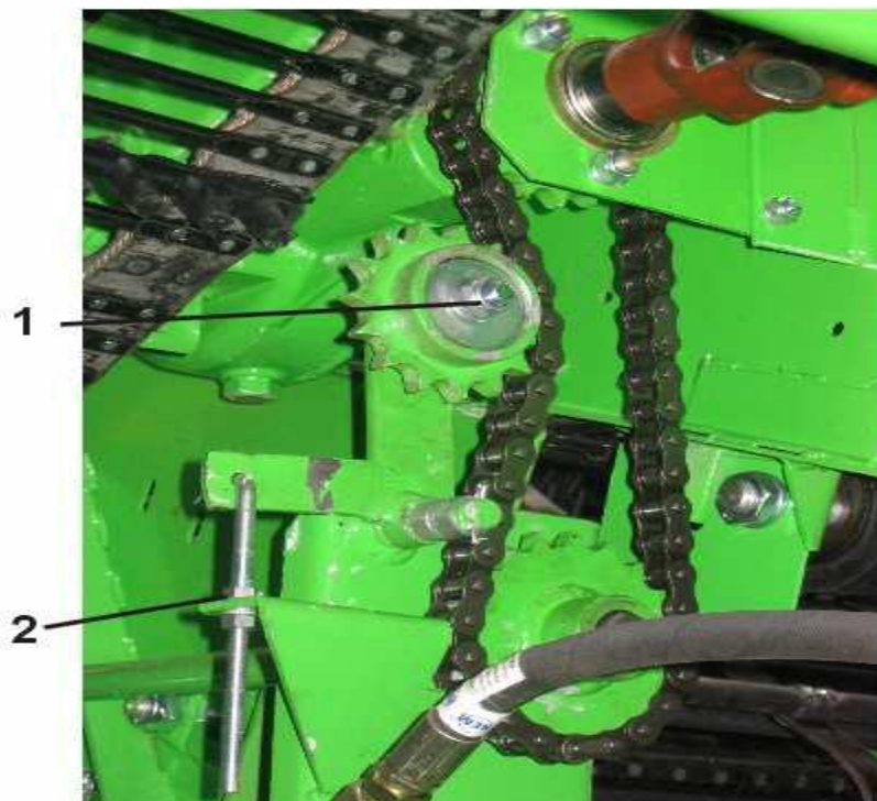
Abb. 41. Spannen der Kette des indirekten Fingerabstreiferantriebs.
