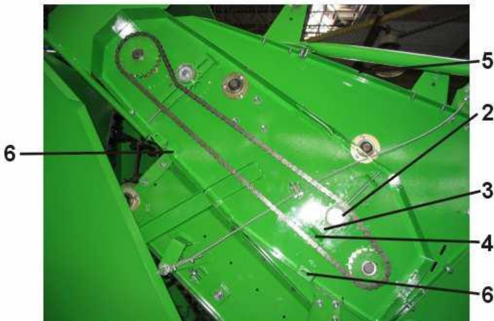
Abb. 38 B. Spannen der Antriebskette des breiteiligen Transporters. 1- Spannwerk, 2- Mutter, 3- Spannwerk, 4- Mutter, 5- Abdeckung des Schutzschields, 6- Schraube.
