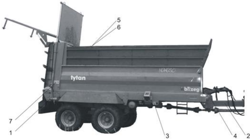
Rys. 1 – Rozmieszczenie znaków bezpieczeństwa na rozrzutniku
